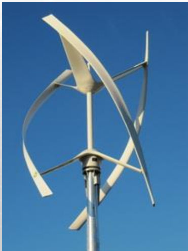
turbina z wirnikami o osi pionowej
